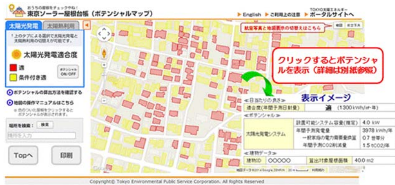
図 7. 「東京ソーラー屋根台帳」による発電ポテンシャル等の GIS (建物ごとに太陽光発電および太陽熱利用の適合度を色で区別、予測値を表示)
