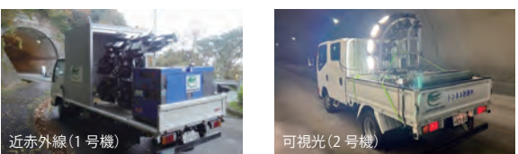
SfM (Structure from Motion): ある対象を撮影した複数枚の写真から対象の三次元形状を復元する技術
