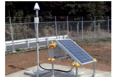
高精度GNSSモニタリング技術「shamen-net」
