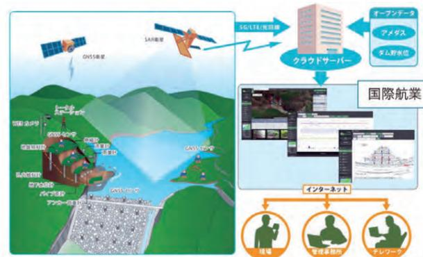
GNSS・IoTセンサ・衛星SARを用いた計測システム説明図
