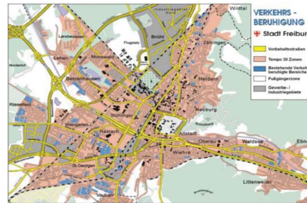
フライブルク市の住宅地域の静穏化 （オレンジの範囲の道路は時速30km以下の規制）
