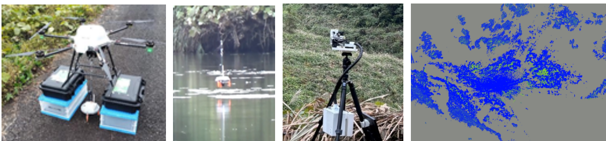
左から水位センサとドローン／ドローンによる遠隔配置／地形形状センサ／取得した地形データ
