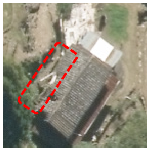
実体写真（１）－③－１：庇・軒の一部が落下、崩壊している、軒がたれ下がっている事例（１）
