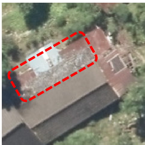
実体写真（1）- ② - 1：屋根ふき材が剥落している事例（1）
