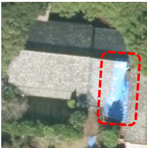
実体写真（1） - ② -4 : 屋根ふき材が剥落している事例（4）
