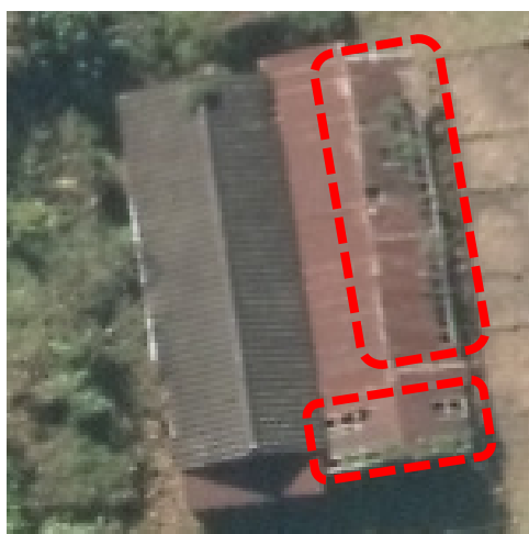
実体写真（1）- ② - 2：屋根ふき材が剥落している事例（2）
