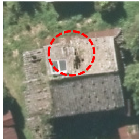
実体写真（1） - ① -4 : 屋根の一部が落下、崩壊している事例（4）
