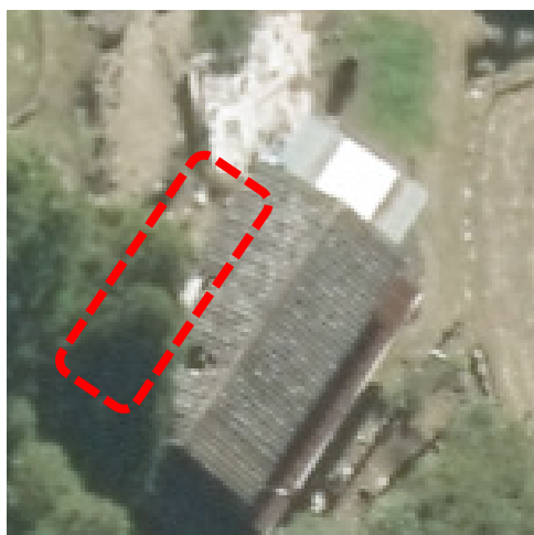
実体写真（１）－③－１：庇・軒の一部が落下、崩壊している、軒がたれ下がっている事例（１）
