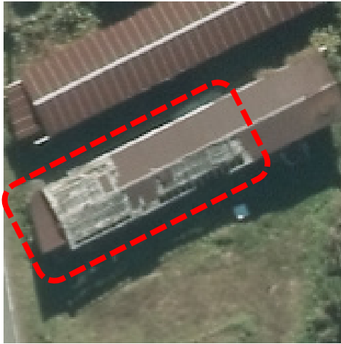
実体写真（1） - ② -3 : 屋根ふき材が剥落している事例（3）
