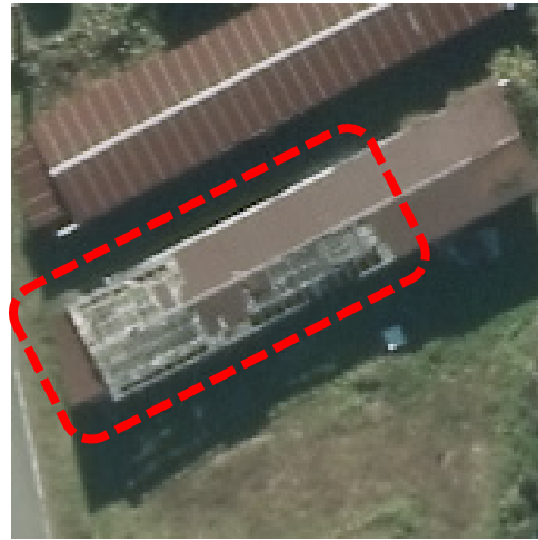
実体写真（1） - ② -3 : 屋根ふき材が剥落している事例（3）
