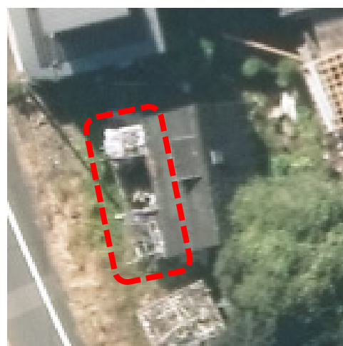
実体写真（１）－③－２：庇・軒の一部が落下、崩壊している、軒がたれ下がっている事例（２）
