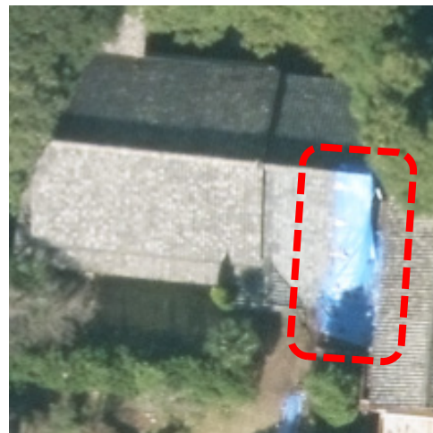
実体写真（1） - ② -4 : 屋根ふき材が剥落している事例（4）
