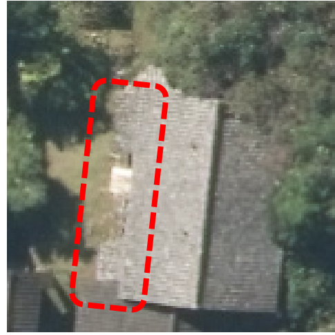
実体写真(1) - ③ - 3 : 庇・軒の一部が落下、崩壊している、軒がたれ下がっている事例(3)
