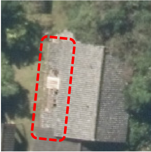
実体写真(1) - ③ - 3 : 庇・軒の一部が落下、崩壊している、軒がたれ下がっている事例(3)
