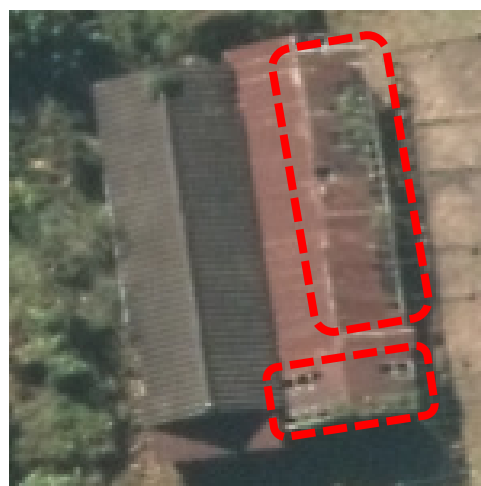
実体写真（1）- ② - 2：屋根ふき材が剥落している事例（2）
