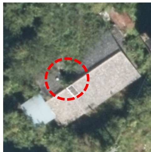
実体写真（1）- ① -2：屋根の一部が落下、崩壊している事例（2）
