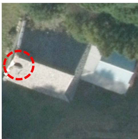
実体写真（1）- ① -1：屋根の一部が落下、崩壊している事例（1）
