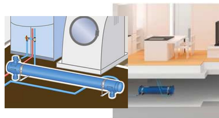
貯留タンクの設置イメージ
