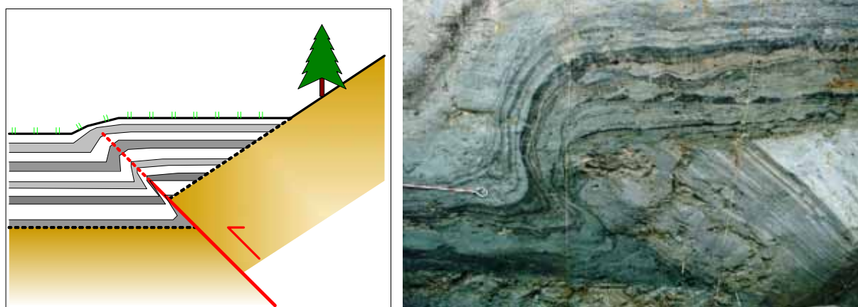
図 3.1 断層と撓曲のイメージおよびトレンチ確認例(森本富樫断層帯：梅田 B トレンチ)
